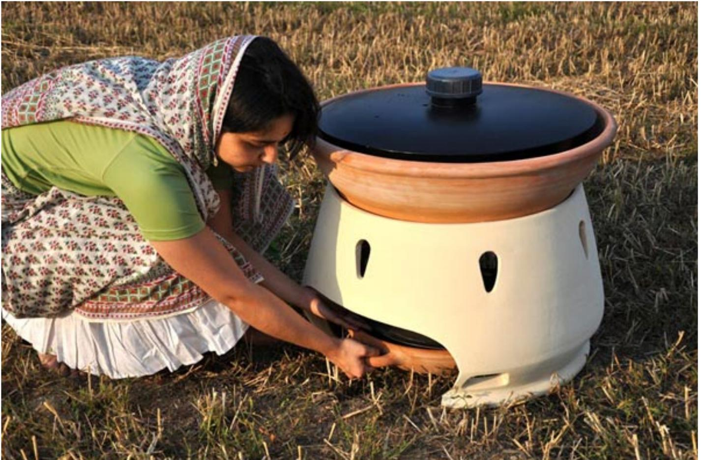
En présence de **soleil**, la **température** et la **pression** augmentent et la vapeur créée est alors dirigée vers le bas à l'aide d'un tuyau de raccordement, où un couvercle joue le rôle de **condenseur**.
