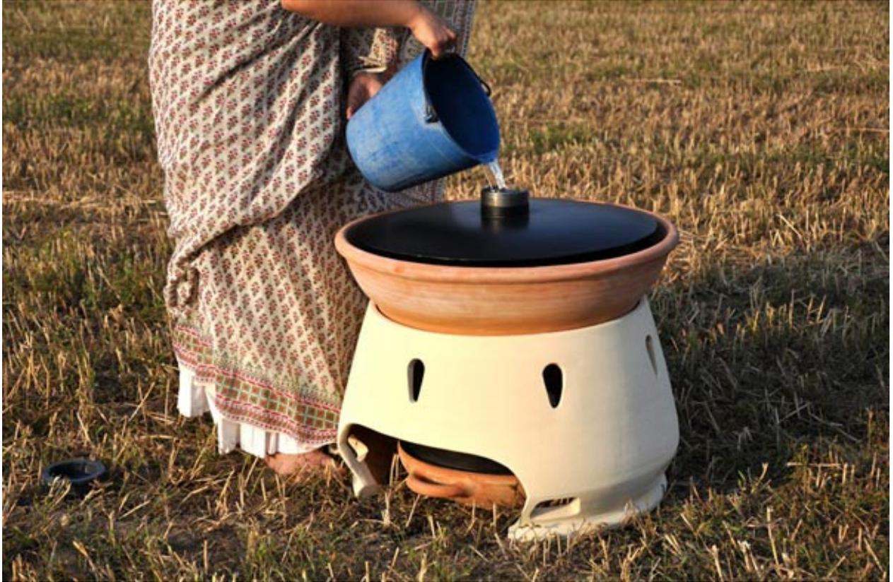
Pour créer Eliodomestico, Gabriele s'est inspiré du **cycle naturel de l'eau**. En effet, l'appareil repose sur le **principe d'évaporation de l'eau**.
